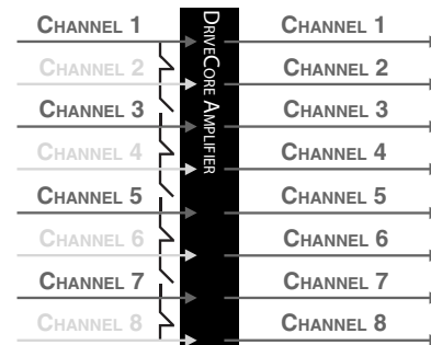
Figura 4.6.5 Direccionamiento de cuatro canales a ocho canales
