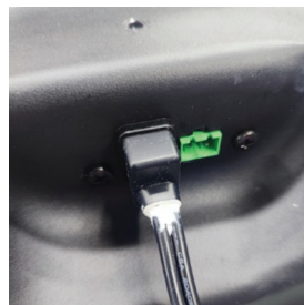
Figura 19A: Añadir pegamento de silicona
